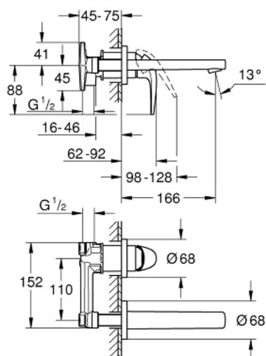
20 288 000 **BAUCURVE FAÇADE POUR MITIGEUR MONOCOMMANDE 2 TROUS LAVABO**
